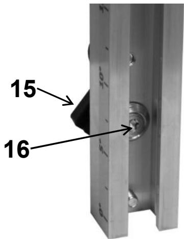
**D** **Teflongleiter (15)** kann mit Schraube (16) exakt nachjustiert werden.
