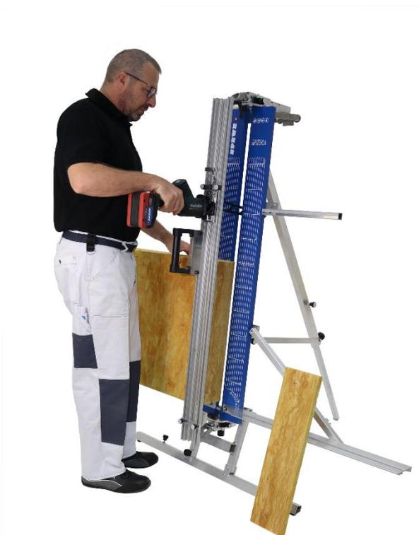
Tout est compatible : l'outil de coupe multi-usages sans fil est compatible avec les scies Metabo. Cela permet de réaliser des coupes précises dans les panneaux isolants épais. **Photo : Spewe**
