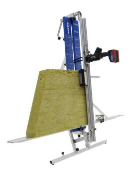
Echter Allrounder: Das Allzweck-Schneidegerät von Spewe ist besonders robust sowie kompakt und eignet sich zum Schneiden von Mineralfasern, Dämmstoffen oder auch Holzfasern und Schaumglas. Die Führungsschlitten sind kompatibel mit Metabo Sägen. **Foto: Spewe**
